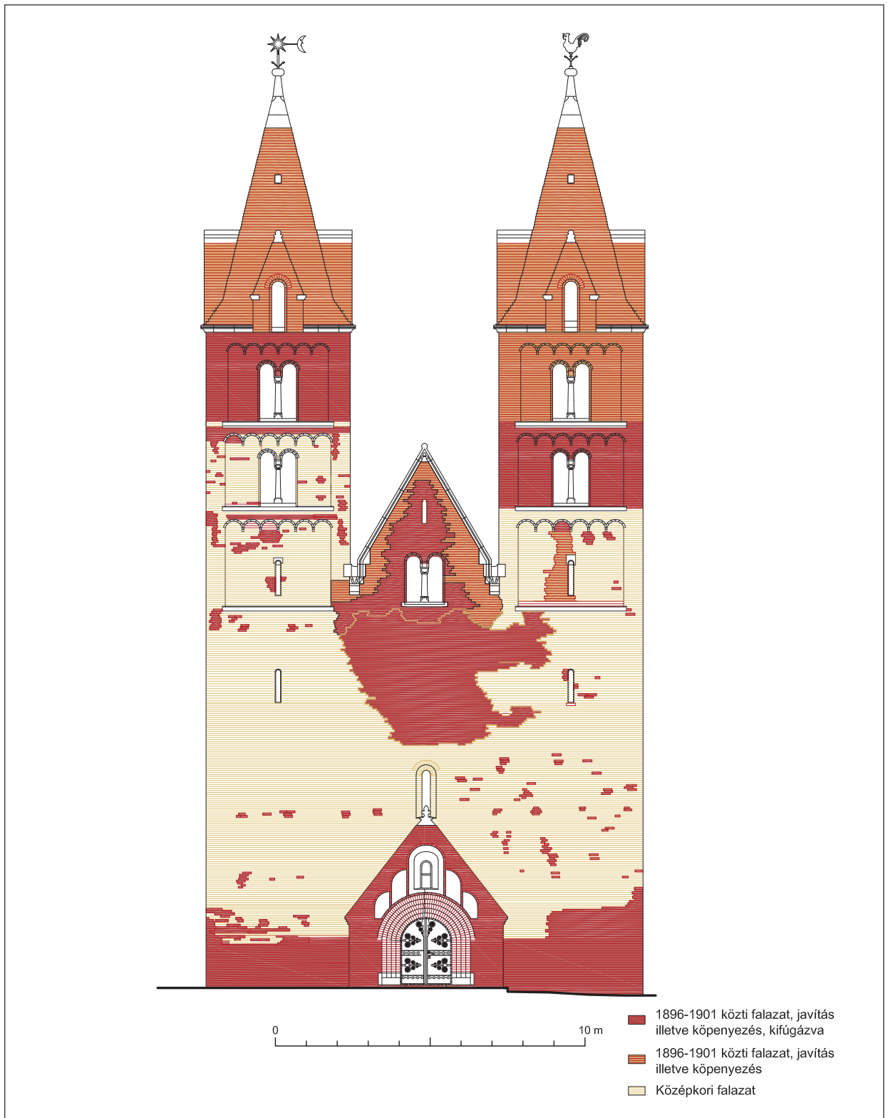
25. Ákos, nyugati homlokzat a restaurálás eredményeivel
